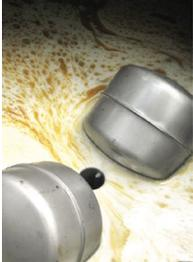
Absaugung der Öle/Partikel von der Badoberfläche durch den RTG Edelstahl Skimmer
